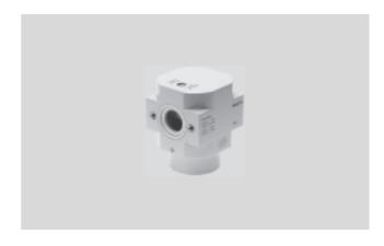
Die Dauer des Druckaufbaus wird über die am Ventildeckel angebrachte Drossel eingestellt. Entsprechend der eingestellten Drosselstellung steigt der Ausgangsdruck p2 langsam an. Bei Erreichen des Durchschaltdrucks öffnet der Hauptsitz.
