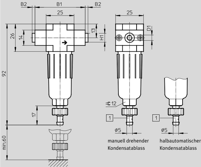
1 Stecknippel für Kunststoffschlauch PCN-4
