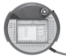
Při vytváření pohybového programu je velmi často známa sekvence pohybů, kdežto přesná poloha, do které je nutné najít, např. poloha chapadla nebo odkládací poloha, známa nebývá. Tyto hodnoty lze určit teprve přímo při uvádění do provozu, a to přesným najetím do dané polohy. Proto systém CMXR v kombinaci s ovládacím zařízením CDSA obsahuje software, který Vás povede pomocí dialogů a který umožňuje snadno a rychle naučit (teach) potřebné polohy.
