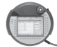
Ovládací zařízení CDSA má nouzový vypínač a také potvrzovací tlačítko se třemi položkami. Obě zařízení pracují po 2 kanálech a jsou připravena pro integraci do bezpečnostního obvodu. Potvrzovací tlačítko slouží k potvrzení výkonu pohonu při seřizovacím provozu. Kromě hardwaru a ergonomického držadla má zařízení CDSA také barevný dotykový displej, z něhož lze také využívat akce, podobně jako z klávesnice.
