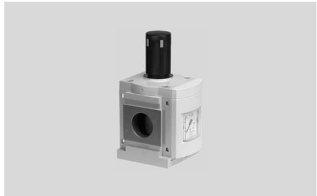
无论系统压力波动如何，也不论耗气量为多少，减压阀始终保持输出压力p2恒定。可以用旋转手柄手动设置，或通过外部先导减压阀的先导压力p12气动设置，
