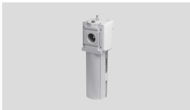
Il lubrificatore proporzionale immette nell'aria compressa una quantità di olio con dosaggio di precisione. La caduta di pressione che si verifica durante il flusso attraverso un ugello Venturi viene sfruttata per convogliare l'olio da un serbatoio allo sgocciolatoio.
