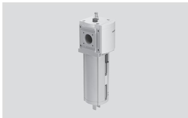
Il lubrificatore proporzionale immette nell'aria compressa una quantità di olio con dosaggio di precisione. La caduta di pressione che si verifica durante il flusso attraverso un ugello Venturi viene sfruttata per convogliare l'olio da un serbatoio allo
