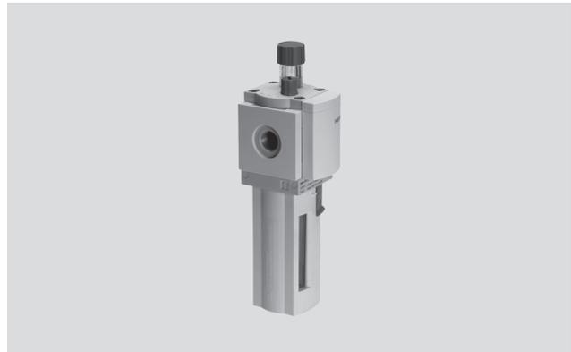
Il lubrificatore proporzionale immette nell'aria compressa una quantità di olio con dosaggio di precisione. La caduta di pressione che si verifica durante il flusso attraverso un ugello Venturi viene sfruttata per convogliare l'olio da un serbatoio allo sgocciolatoio. Da qui, la goccia d'olio
