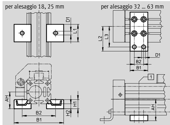
1 Supporto centrale collocabile in qualsiasi posizione lungo il profilo
