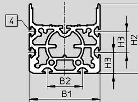
4 Rainure pour écrou de fixation
