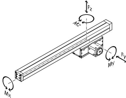
Si plusieurs des forces et couples mentionnés ci-dessous agissent simultanément sur le bras mobile, respectez les charges maximales indiquées et appliquez les équations suivantes :
