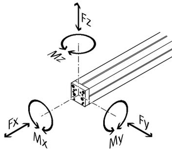
Si plusieurs des forces et couples mentionnés ci-dessous agissent simultanément sur le bras mobile, respectez les charges maximales indiquées et appliquez les équations suivantes :
