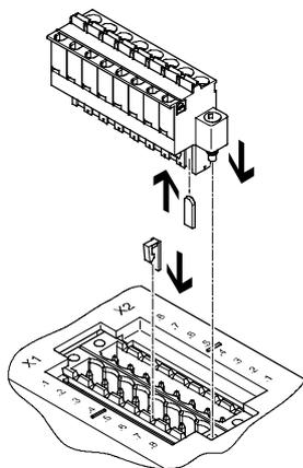
Les blocs de raccordement CPX-P-AB-2XKL-8POL et les connecteurs femelles NECU-L3G8 peuvent être affectés les uns aux autres à l'aide des éléments de codage CPX-P-KDS-AB-2XKL.
