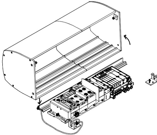
Le capot CPX CAFC est une alternative plate et économique à l'armoire de commande.
