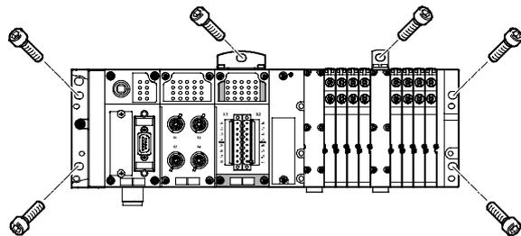
Des trous de fixation pour le montage sur rail sont aménagés dans les plaques d'extrémité du terminal CPX-P, du terminal de distributeurs et dans l'interface pneumatique. Pour les terminaux plus importants, il est possible de se procurer des fixations supplémentaires.
