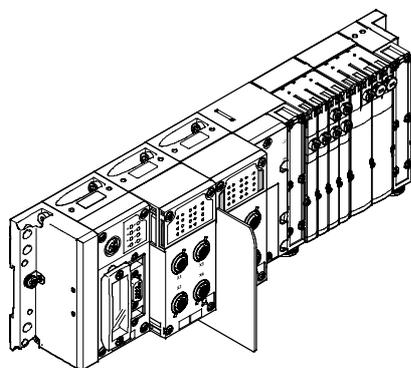
Le terminal CPX-P électrique est un système périphérique pour terminaux de distributeurs.
