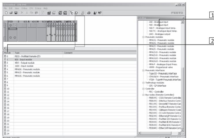
La configuration d'appareil peut être créée, paramétrée et enregistrée simplement par glisser-déposer. Vous pouvez ajouter et déplacer des modules.
