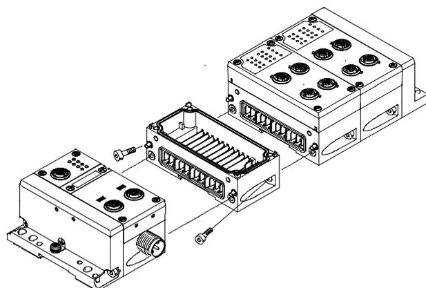
Les modules CPX-P sont reliés mécaniquement par une vis oblique.
