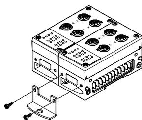
Des équerres de fixation destinées au terminal CPX-P, à visser sur chaque module d'interconnexion, sont disponibles pour les terminaux de distributeurs plus longs.
