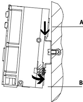
Le montage sur rail est indiqué sur le profil arrière des modules d'interconnexion CPX-P. Le terminal CPX-P se verrouille sur le rail via les fixations pour rails. Pour cela, il suffit d'accrocher le terminal CPX-P sur le rail (flèche A).
