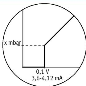
En la práctica se tiene la posibilidad que en la entrada del valor nominal del regulador VPPM se reciba una tensión o una intensidad residual a través del emisor de valor nominal. Para que la válvula evacue el aire fiablemente si el valor nominal es cero, se recurre a la supresión del punto cero.
