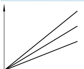
Estado de entrega: el 100% del valor nominal es igual al 100% del valor de la señal de salida. La adaptación o el ajuste del margen de presión permite adaptar el valor de salida al valor nominal.
