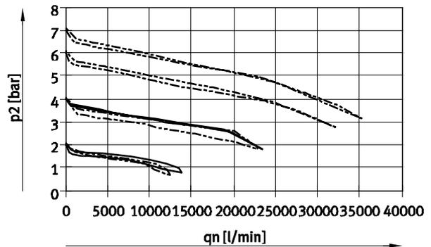
Regulador piloto externo, margen de regulación / tipo de accionamiento PO
