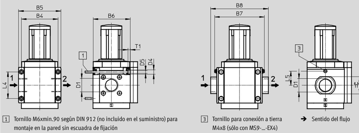
1 Tornillo M6xmin.90 según DIN 912 (no incluido en el suministro) para montaje en la pared sin escuadra de fijación
