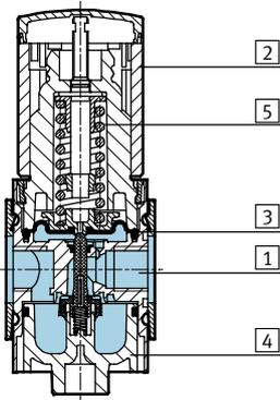
Válvula reguladora de presión (montaje en batería)
