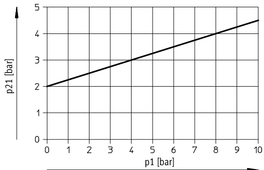
Pilotaje p_{21} en función de la presión de funcionamiento p_1
