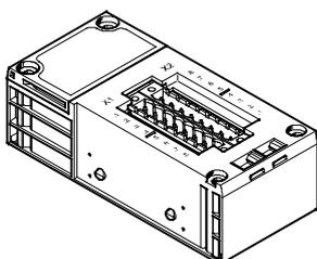
Montaje directo en la máquina (placa de alimentación con clase de protección IP65)
