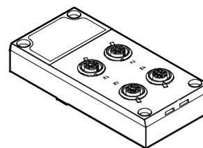
Montaje directo en la máquina (placa de alimentación con clase de protección IP65/IP67)
