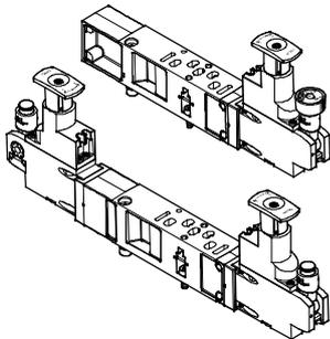
Für die Beeinflussung der Kraft des angesteuerten Aktuators kann zwischen Grundplatte (Verkettungsplatte) und Ventil ein einstellbares Druckregelventil eingebaut werden.
