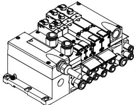
Die Signalansteuerung von der Steuerung zur Ventilinsel erfolgt über ein mehradriges vorkonfektioniertes Kabel oder selbstkonfektionierbaren Multipolanschluss (Zugfederklemme). Dadurch wird der Installationsaufwand erheblich reduziert.
