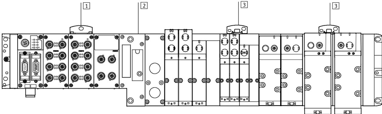
1 Wand-Zusatzbefestigung für CPX-Metall
