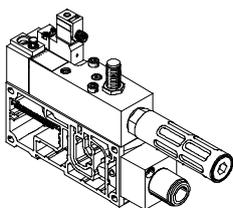
Das Druckaufbauventil wird unabhängig vom Multipol-, AS-Interface- oder Feldbus-Anschluss separat elektrisch angesteuert mit 4-poligem Stecker nach Norm ISO 15407-1 oder optional mit einem M12-Adapter.
