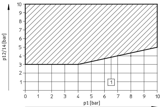
1 Arbeitsbereich für Ventile mit externer Steuerluftversorgung
