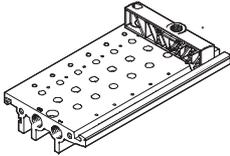
Auf der Anschlussleiste werden die Halbmuffenventile in die Nut eingeklinkt und mit nur einer Schraube festgezogen.
