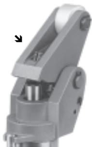
Integrierter Stoßdämpfer: Absorbiert die Aufprallenergie und bremsen den Werkstückträger sanft und geräuscharm ab. Anpassung der Aufprallenergie durch Regulierschraube im Kipphebel.
