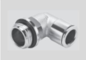
Metalsteckverschraubung zum attraktiven Preis für Pneumatik-anwendungen mit einem Temperaturbereich bis 70 °C und einem Druckbereich bis 16 bar. Schlauch-Außen-Ø 3, 4, 6, 8, 10, 12 und 14 mm mit Anschlussgewinde M5, M7 und G $\frac{1}{8}$  ... G $\frac{1}{2}$ .
