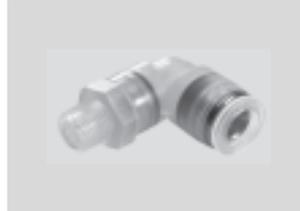
Polypropylenverschraubung für den Einsatz bei Anwendungen mit extremen Medieneinflüssen. Für Pneumatikanwendungen mit einem Temperaturbereich bis 60 °C und einem Druckbereich bis 10 bar. Schlauch-Außen-Ø 4, 6, 8, 10 und 12 mm mit Anschlussgewinde von R $\frac{1}{8}$  ... R $\frac{1}{2}$ .
