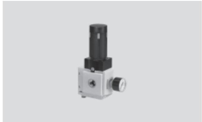
des Druckregelbereichs entweder manuell mit dem Drehknopf oder pneumatisch über einen Steuerdruck p12 von einem externen Pilotregler (möglichst mit einem Präzisions-Druckregelventil) einstellbar. Beim Abschalten des Eingangsdrucks p1 wird der Ausgangsdruck p2 über den Anschluss 3 (Sekundärentlüftung) entlüftet.
