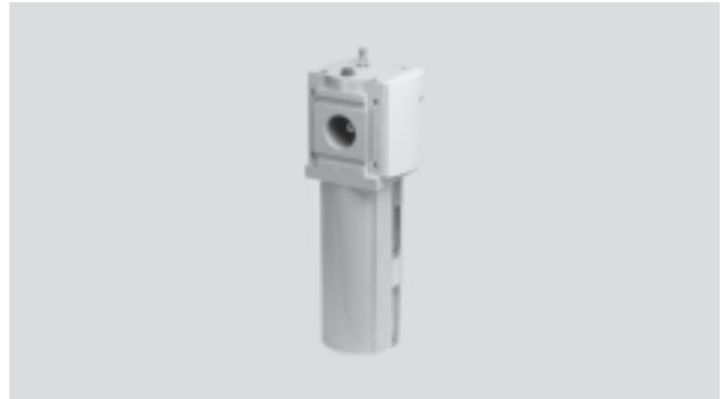
Der Proportional-Öler führt der Druckluft eine fein dosierbare Ölmenge zu. Das Druckgefälle, das beim Durchströmen einer Venturidüse entsteht, wird benützt, um aus einem Behälter Öl bis zur Abtropf-
