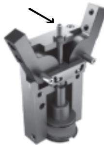
Mit Hilfe der Hubreduzierung HGRT-HR, die als Zubehör bestellt werden kann, kann der Öffnungswinkel durch eine Einstellschraube begrenzt werden. Somit kann auf einfache Weise der Radialgreifer in einen Winkelgreifer umgebaut werden.
