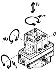
Die angegebenen zulässigen Kräfte und Momente beziehen sich auf einen Greifbacken. Die angegebenen Werte beinhalten den Hebelarm, zusätzliche Gewichtskräfte durch das Werkstück bzw. durch externe Greiffinger
