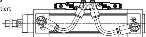
Monostabiles Ventil unbetätigt, Kolbenstange ausgefahren
