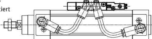
Bistabiles Ventil unbetätigt, Kolbenstange eingefahren
