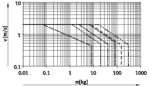
Kolben-Ø 8 ... 63 mit YSR-Dämpfung
