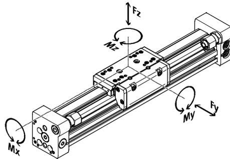
Wirken gleichzeitig mehrere der unten genannten Kräfte und Momente auf den Antrieb, müssen neben den aufgeführten Maximalbelastungen folgende Gleichung erfüllt werden:
