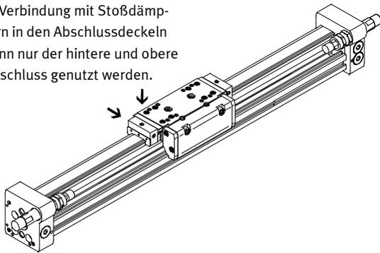
In Verbindung mit Stoßdämpferhalter DADP kann nur der vordere und obere Anschluss genutzt werden.
