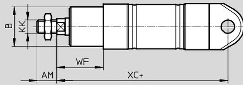
MQ-K3 – kurzer Abschlussdeckel ohne Schwenkbefestigung, mit Innengewinde an der Kolbenstange
