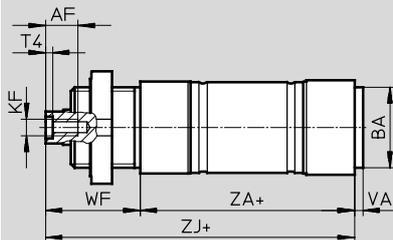
MG-K3 – Lagerdeckel ohne Befestigungsgewinde, mit Innengewinde an der Kolbenstange
