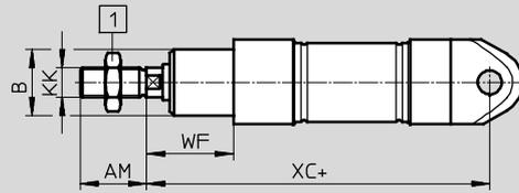
MQ-K3 – kurzer Abschlussdeckel ohne Schwenkbefestigung, mit Innengewinde an der Kolbenstange
