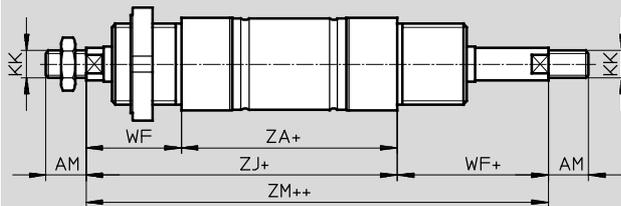
S2-K3 – Durchgehende Kolbenstange, mit Innengewinde
