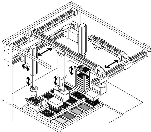
Zuführung von Werkstücken mit gleichzeitiger Qualitätsprüfung über ein Kamerasystem
