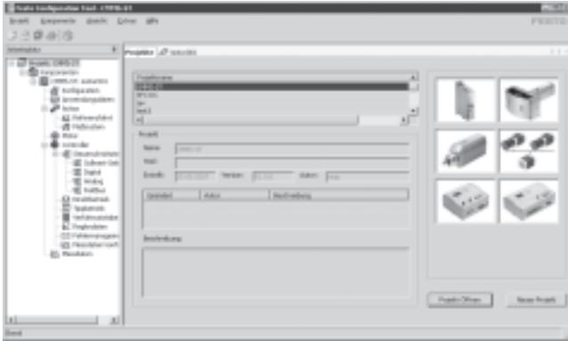
Schnell, sicher und einfach, dass sind wesentliche Anforderungen an eine Software zur Produktkonfiguration. Die Mehrachssteuerung CMXR wird, wie andere Produkte von Festo auch, über das Festo Configuration Tool (FCT) konfiguriert. In der Konfiguration werden elektrische Größen (z. B.
