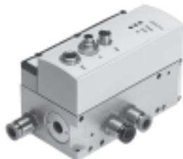
Proporcionální ventil 5/3 pro úlohy se systémem Soft Stop a pneumatickým polohováním. Plně digitalizován – s integrovanými tlakovými čidly, s novými diagnostickými funkcemi. Ve velikostech 4, 6 a 8. Průtok 350, 700 a 1 400 l/min.
