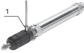
Il kit a soffietto è un sistema a tenuta. Per evitare l'aspirazione di sostanze indesiderate, l'alimentazione e lo scarico sono convogliati attraverso un foro nella parte di collegamento 1.
