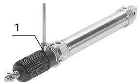
Il kit a soffietto è un sistema a tenuta. Per evitare l'aspirazione di sostanze indesiderate, l'alimentazione e lo scarico sono convogliati attraverso un foro nella parte di collegamento 1. Questo kit assicura la protezione interna dello stelo, della guarnizione
