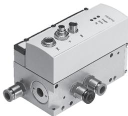
Valvola proporzionale 5/3 per applicazioni con Soft Stop e posizionamento pneumatico. Completamente digitalizzata, con sensori di pressione integrati, con nuove funzioni diagnostiche. Disponibile nelle dimensioni 4, 6 e 8. Portate da 350, 700 e 1400 l/min.
