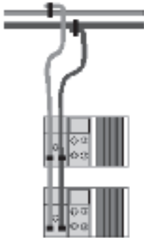
Installazione standard su interfaccia AS-i con cavo piatto
