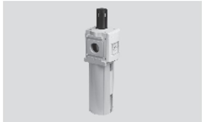
Dans cet appareil, le filtre et le manodétendeur constituent une seule et même unité. Le filtre fritté avec séparateur d'eau débarrasse l'air comprimé des impuretés, des particules, de la rouille et de l'eau de condensation.
