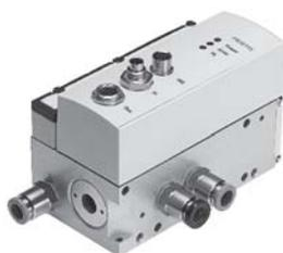
Distributeur proportionnel 5/3 pour les applications avec Soft Stop et positionnement pneumatique. Entièrement numérisé, avec capteurs de pression intégrés et nouvelles fonctions de diagnostic. Tailles 4, 6 et 8. Débit de 350, 700 et 1 400 l/min.
