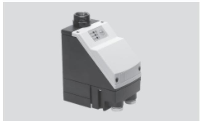
El condensado llega a la válvula de purga a través del taladro que se encuentra en el fondo del vaso del filtro. Finalmente, se acumula en un recipiente. Mediante un detector capacitivo se controla el nivel del condensado en el recipiente. Una vez que se alcanza el nivel máximo, se abre una válvula de membrana y el
