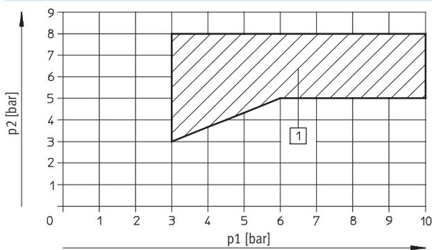
1) Margen de funcionamiento de válvulas con alimentación externa del aire de pilotaje
