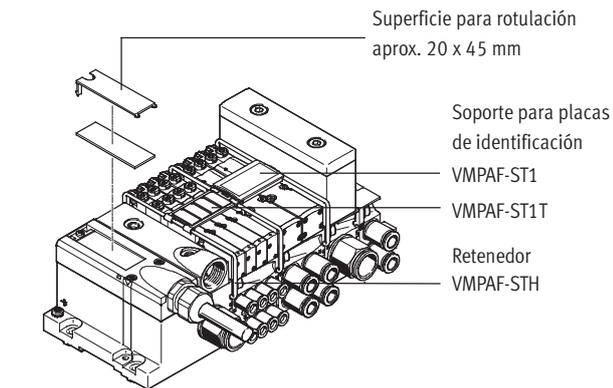
Para identificar las válvulas puede montarse en cada placa de alimentación un soporte de placas rotulables VMPAF-ST1 (nº de art. 546 228, código T en el código de pedido) o VMPAF-ST1T (nº de art. 544 422, con placas de identificación IBS-9x20). A modo de alternativa o adicionalmente pueden colocarse placas de
