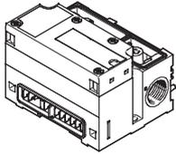
La presión puede alimentarse al terminal de válvulas MPA-F en una o varias conexiones. El terminal MPA-F tiene canales y conexiones de alimentación de secciones especialmente grandes. Por lo general, no es necesario utilizar placas de alimentación adicionales.
