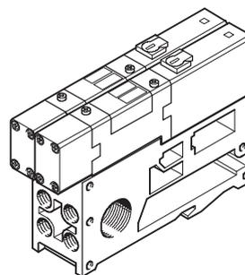
En el caso de las válvulas MAXI, las zonas de presión diferentes se consiguen intercalando una placa ciega. En ese caso, la alimentación se realiza a través de la placa de adaptación.
