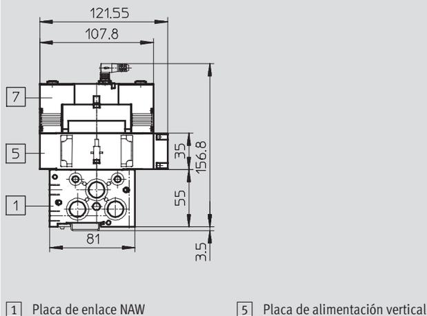
Con placa de enlace y electroválvula (conector tipo clavija, forma C)
