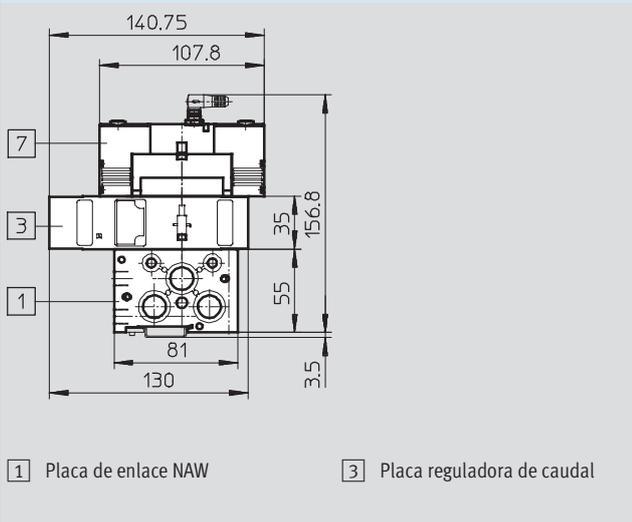
Con placa de enlace y electroválvula (conector tipo clavija, forma C)
