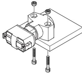
Fijación con brida, tornillos y pasadores cilíndricos
