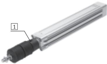
El fuelle no tiene fugas. Con el fin de evitar la aspiración de fluidos no apropiados, la pieza de conexión <sup>1</sup> tiene un taladro para alimentación y descarga común del aire.
