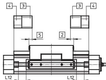
En un eje accionado por husillo y con tope elástico, se reduce la carrera útil ya que la carrera de reserva es menor que la suma de las dimensiones del tope elástico y del soporte del amortiguador. La reducción de la carrera útil varía según el tamaño del eje.
