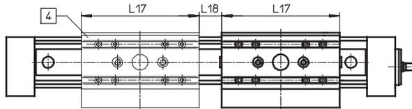
Combinando un eje accionado por husillo con un carro adicional, se reduce la carrera útil en función de la longitud del carro adicional y de la distancia entre los dos carros.
