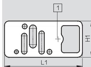
1 keine Bohrung, Steuerluftversorgung extern
