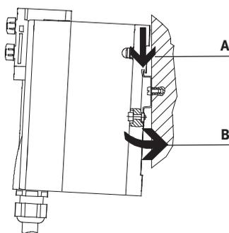
Die VTSA/VTSA-F Ventilinsel wird in die Hutschiene eingehängt (siehe Pfeil A). Danach wird die VTSA/VTSA-F Ventilinsel auf die Hutschiene geschwenkt und durch das Klemmstück befestigt (siehe Pfeil B).
