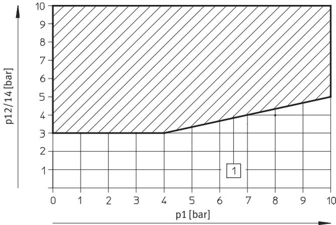
1) Arbeitsbereich für Ventile mit externer Steuerluftversorgung
