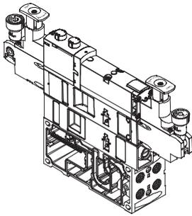
Auf jedem Ventilplatz können zwischen Grundplatte und Ventil weitere Funktionseinheiten eingefügt werden. Diese, mit Höhenverkettung bezeichneten Funktionen,
