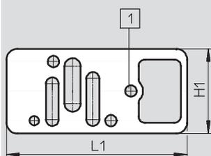
1 Bohrung, Steuerluftversorgung intern
