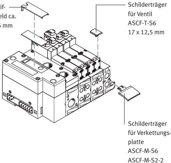
Zur Kennzeichnung der Ventile und der Verkettungsplatten können Schilderträger montiert werden. Über Code B bzw. T im Bestellcode Zubehör können diese gleich mitbestellt werden. Lieferumfang: Schilderträger inklusive Bezeichnungsschild. Dazu passen im Ersatzteilfall die Bezeichnungsschilder:
