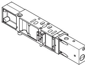
Mit einem Schalter ausgestattet über den die Druckversorgung abgesperrt werden kann. Damit kann ein Wege-Magnetventil oder eine nachfolgende Höhenverkeftungplatte ausgetauscht werden ohne die Gesamtluftversorgung abzuschalten. Ist die Steuerkette redundant angelegt, kann auch bei einer zyklischen
