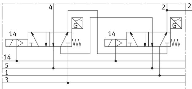
Beim Steuerblock mit Sicherheitsfunktion VOFA-B26-T52... für die Ventilinsel werden zwei 5/2-Wege-Magnetventile, Baubreite 26 mm,
