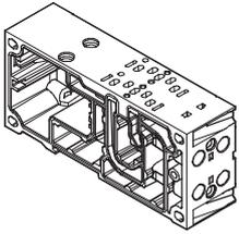
VTSA/VTSA-F basiert auf einem modularen System, bestehend aus Verkettungsplatten und Ventilen. Verkettungsplatten gibt es für Ventile Baubreite 18 mm, und Baubreite 26 mm im Doppelraster, d. h. zwei Ventile pro Verkettungsplatte. Für Ventile der Baubreite 42 mm und 52 mm gibt es Verkettungsplatten mit einem Ventil pro Verkettungsplatte. Die Verkettungsplatte enthält eine Kanaldichtung und eine elektri-
