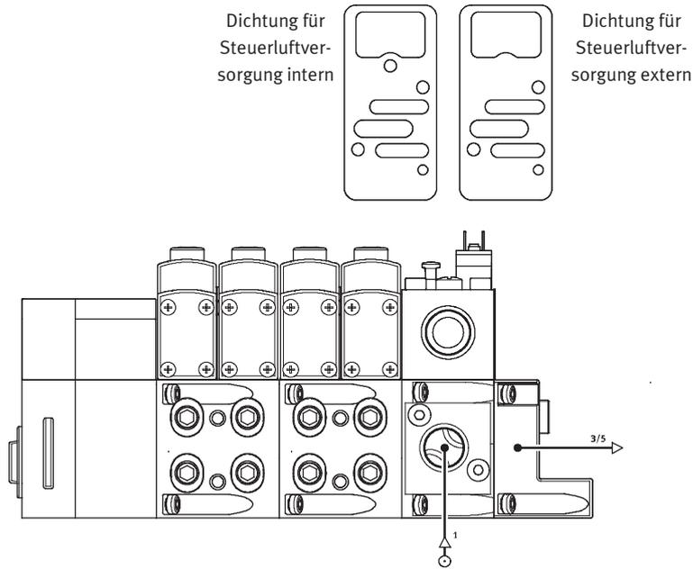
1) Bei dieser Konstellation ist eine rechte Endplatte mit Codierdeckel nicht möglich, da hierüber keine Abluft abgeführt werden kann
