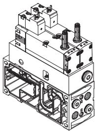
Die Ventile mit integrierter Kolbenstellungsabfrage auf Verkettingsplatte für Ventilinsel VTSA/VTSA-F müssen unabhängig von der Art der elektrischen Ansteuerung der Ventilinsel (Einzel-, Multipol- oder Feldbus-/Steuerblockanschluss) elektrisch versorgt werden.
