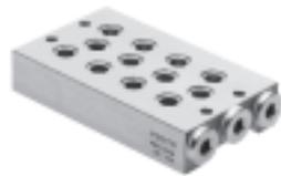
Die Ventile Tiger Classic können auf PAL-Anschlussleisten mit gemeinsamem Druckluftanschluss oder auf PRS-Anschlussblöcken mit gemeinsamem Druckluftanschluss und gemeinsamen Entlüftungen montiert werden. Die Ventile werden mit Hohlschrauben an den Leisten und Blöcken befestigt.
