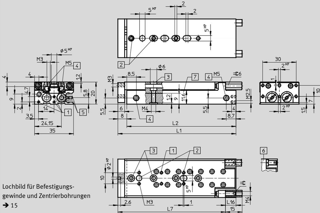
Lochbild für Befestigungsgewinde und Zentrierbohrungen
