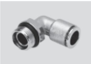
Vollmetallsteckverschraubung mit verchromter Oberflächenvergiftung. Hohe Korrosionsbeständigkeit KBK3 und Chemikalienresistenz mit Zulassung in der Nahrungsmittel- und Verpackungsindustrie. Für Pneumatikanwendungen mit einem Temperaturbereich bis 150 °C und einem Druckbereich bis 16 bar.
