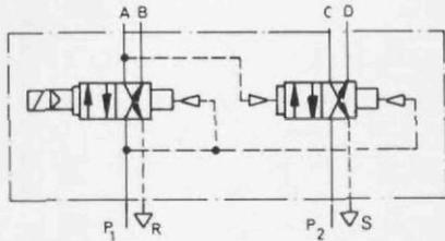
Mit diesem Ventil können Funktionen von Festo Taktvorschubgeräten, wie Vorschubbewegung und wechselweise Spannen, gesteuert werden.
