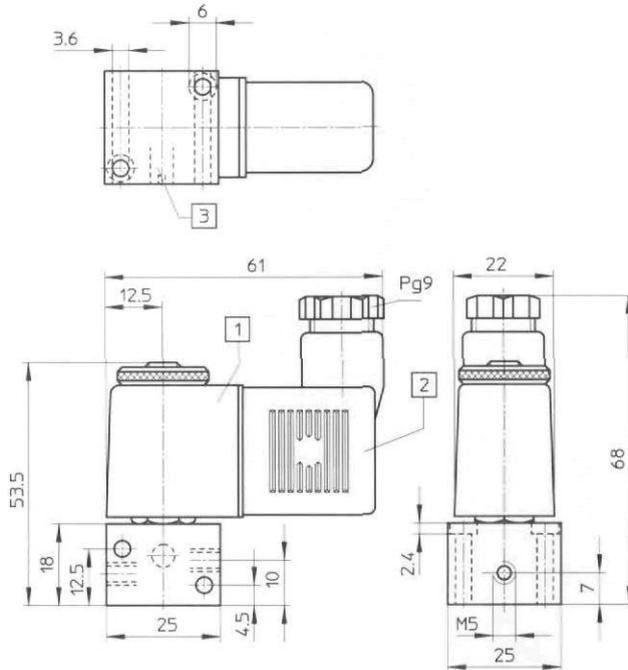
Zulässiges Anzugsdrehmoment der Befestigungsmutter für Magnetspule = 150 Ncm (15 kpcm)
