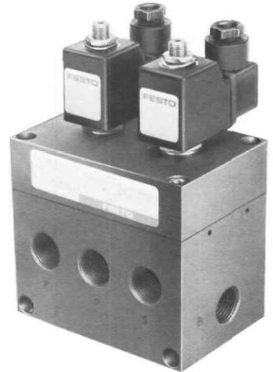
Diese Ventile halten in Nullstellung den Kolben eines doppelwirkenden Zylinders unter Druck eingespannt. Sie eignen sich daher speziell zur Positionierung, zum Stoppen bei Not-Halt und zum Festhalten von doppelwirkenden Zylindern in jeder beliebigen Stellung.
