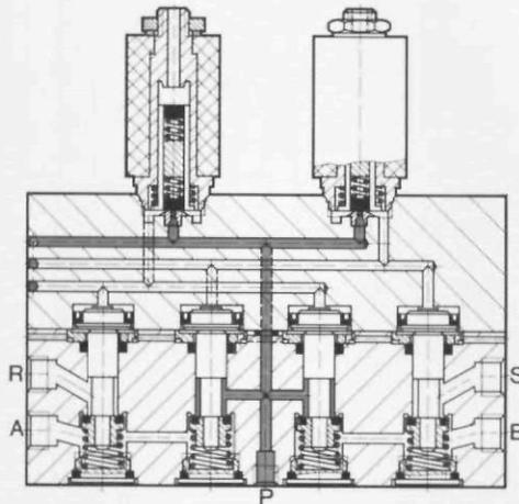
Diese Ventile halten in Nullstellung den Kolben eines doppelwirkenden Zylinders unter Druck eingespannt.
