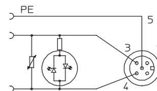
KMEB-1/KMEB-3 ohne integrierte Signalzustandsanzeige
