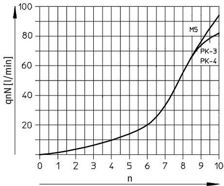
Normaldurchfluss  $q_n$  bei 6  $\rightarrow$  0 bar
