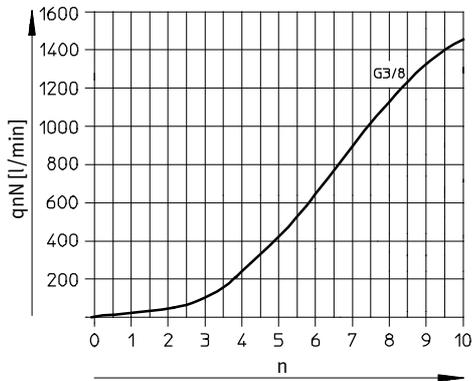
Normaldurchfluss  $q_n$  bei 6  $\rightarrow$  0 bar
