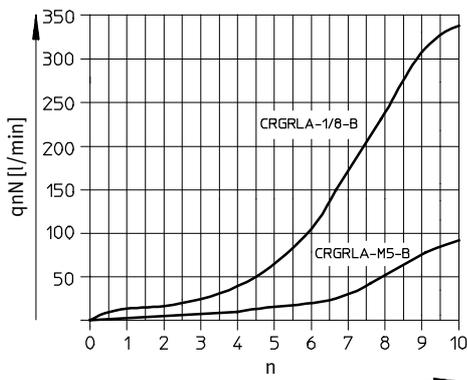
**Normaldurchfluss q<sub>n</sub> bei 6 → 0 bar
