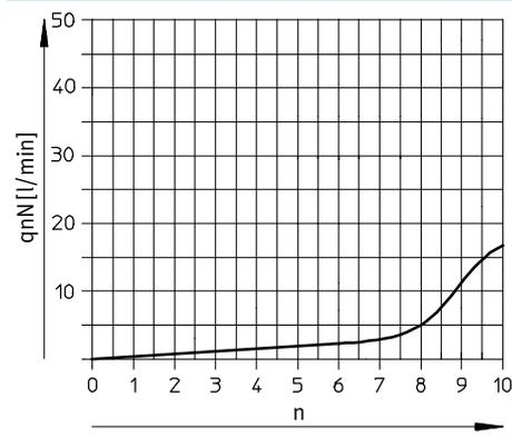
**Normaldurchfluss  $q_n$  bei 6 → 0 bar
