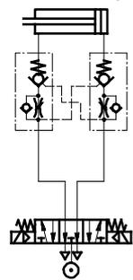
Die Funktionskombination besteht aus einem Drossel-Rückschlagventil mit entsperbarem Rückschlagventil. Solange ein Steuersignal vom pneumatischen Anschluss 21 anliegt, wirkt die Abluftdrosselung. Liegt kein Steuersignal an, sperrt das Ventil die Abluft. In Zufuhrichtung strömt die Druckluft über das Rückschlagventil unge-drosselt
