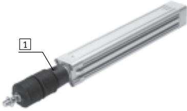
Der Faltenbalgbausatz ist ein leckage-freies System. Um das Ansaugen von unerwünschten Medien zu vermeiden, ist die Zu- bzw. Abluft des Bausatzes über eine Druckausgleichsöffnung im Anbindungsteil **1** gefasst. Der Bausatz schützt die Kolben-
