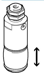
Die angegebenen Öffnungs- und Schließzeiten [ms] wurden bei Raumtemperatur, 6 bar Betriebsdruck und bei senkrecht eingebautem Greifer gemessen. Die Zeiten beziehen sich auf den unbelasteten Greifer.
