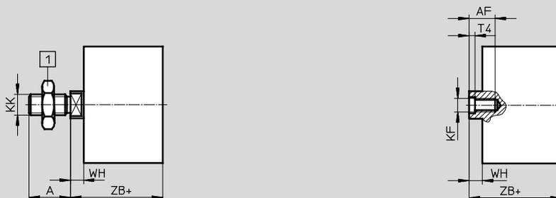
1 Sechskantmutter DIN 439-B nur bei Ø 32 ... 50
